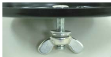
蝶ナットが緩んでもボルトを カットした部分で蝶ナットがとまります。 これにより器具の落下を防止します。
